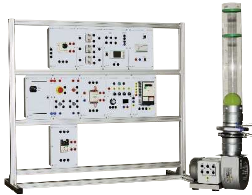
Maquette d'amélioration de l'efficacité énergétique à l'aide de composants standards de variation de vitesse
