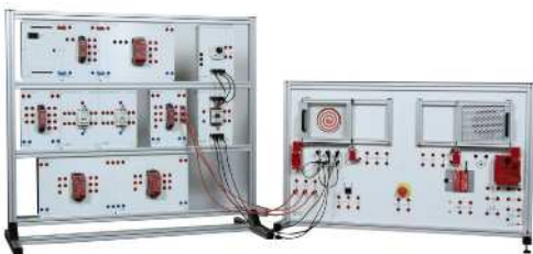
Partie commande du lot sécurité machine et partie opérative du lot sécurité machine
